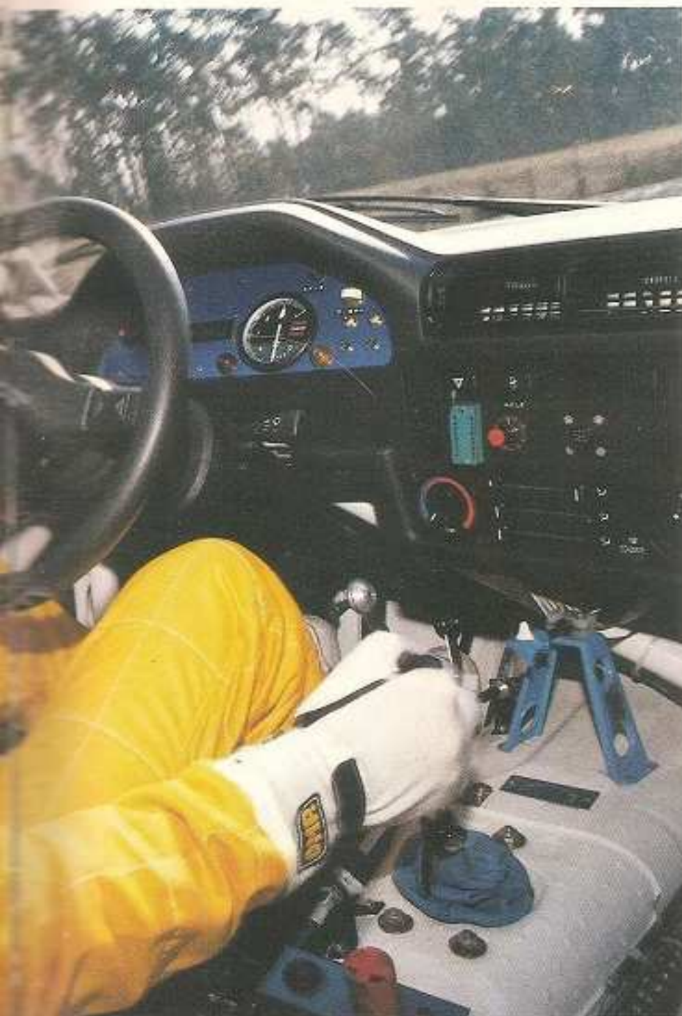
Schaltzentrale: Auf Sonderwunsch gibt es den 330 PS starken Renn-M3 auch mit dem 38 000 Mark teuren Sechsganggetriebe. Vor dem Schaltstock befinden sich die Hebel für die Stabi-Verstellung sowie das Handrad, mit dem die Bremsbalance justiert wird
