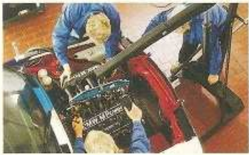
Nun folgt jener Arbeitsgang, den die Autobauer Hochzeit nennen. Der Motor wird im Maschinenabteil versenkt.
