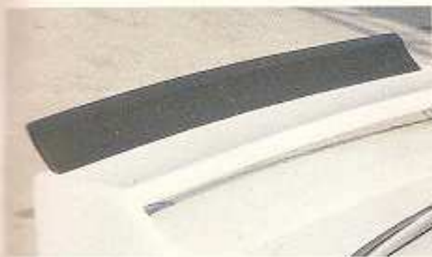
Lippen-Bekennnis: Im Sinnes des optimalen Antriebs bekam der M3 Sport Evolution vorne und hinten jeweils vierstufig verstellbare Spoilerlippen. Die riesigen 18-Zoll-Felgen schaffen Platz für monströse Sechs-Kolben-Bremssättel
