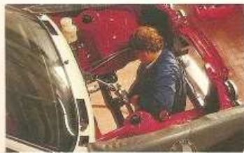
Der Einbau der Lenkung erfordert besondere Sorgfalt. Im Renn-M3 muß der Fahrer ohne Servounterstützung auskommen.
