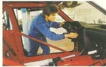
Der Elektriker benötigt zwei Tage, bis alle Strippen fachgerecht verlegt sind.
