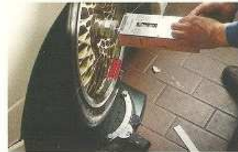
Schließlich wird die Fahrwerksgeometrie eingestellt. Das M3-Fahrwerk bietet rund 1000 Möglichkeiten, Wichtiges falsch zu machen.
