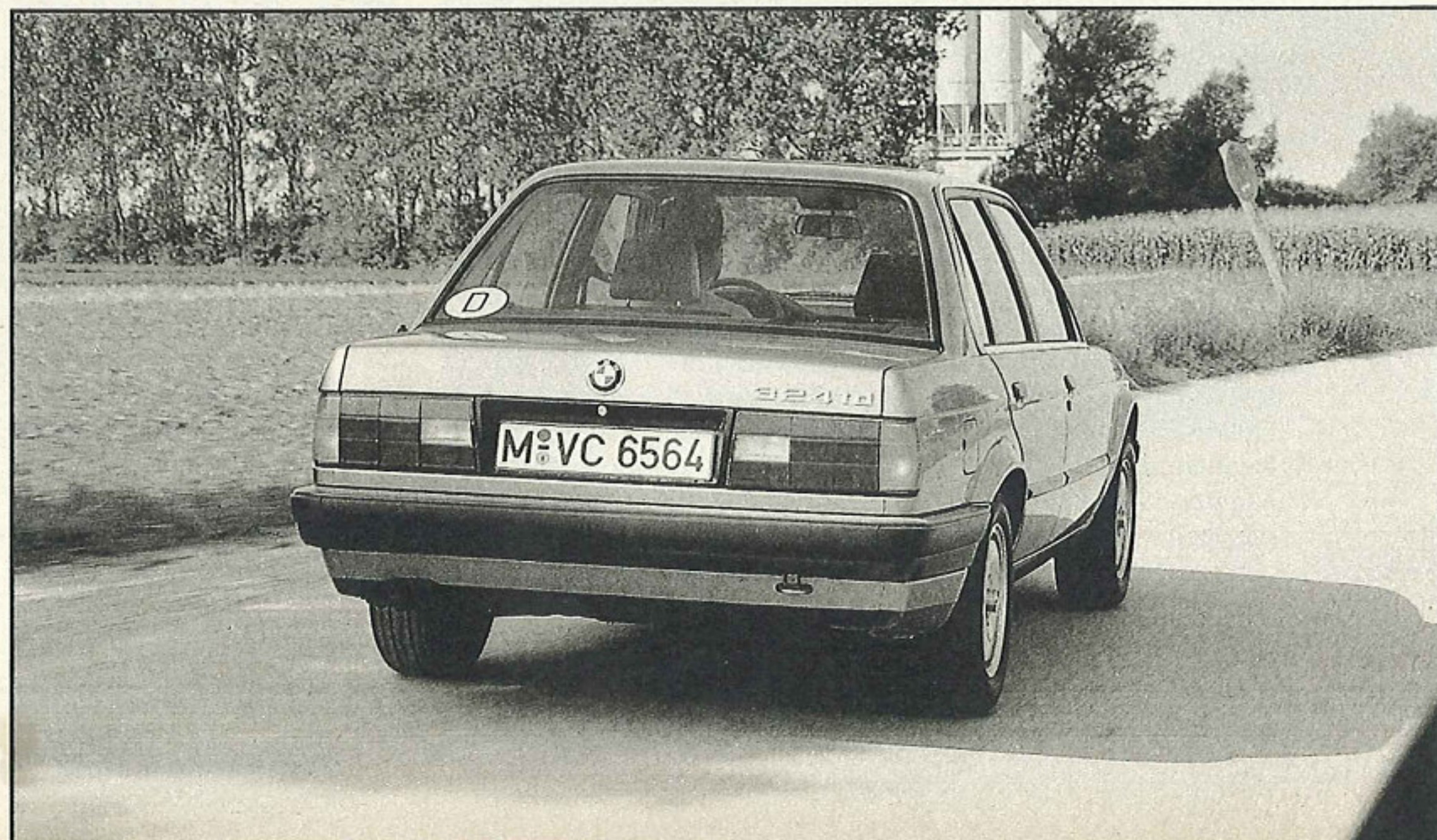
Neue Kunststoff-Stoßstangen absorbieren kleine Stöße ohne bleibende Schäden; das Heck wirkt mit den größeren Leuchteinheiten markanter
