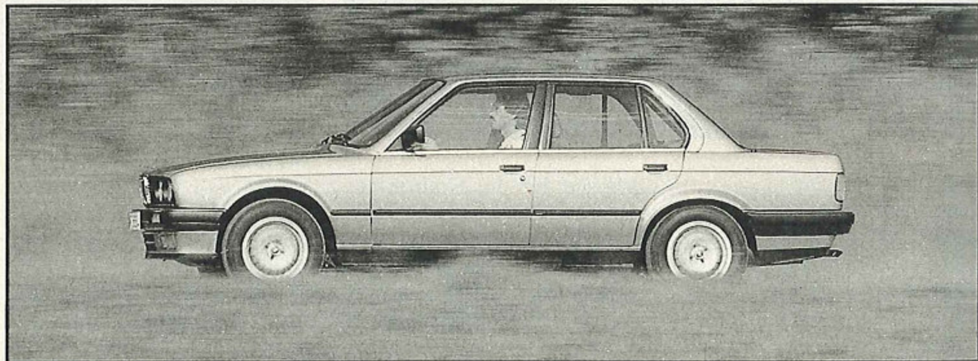
Neue Kunststoff-Stoßstangen absorbieren kleine Stöße ohne bleibende Schäden; das Heck wirkt mit den größeren Leuchteinheiten markanter
