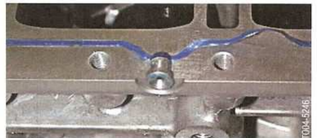
3 - Einspritzöffnung am Kurbelgehäuse für die Flüssigabdichtung
