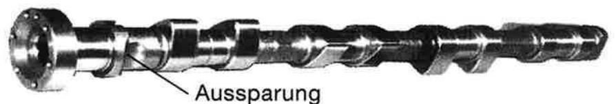
Abb. 23: Nockenwelle mit Montageaussparung
