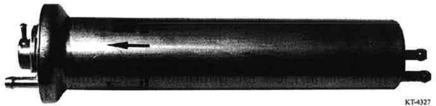
Abb. 19: S62 Kraftstofffilter mit Druckregler (analog M62)
