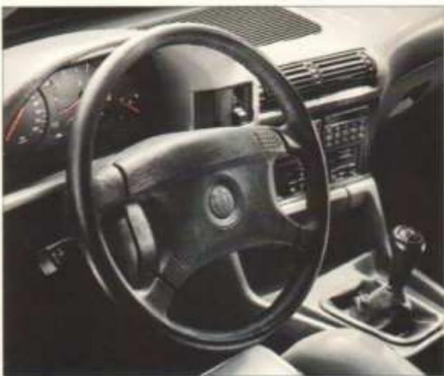
**18** BMW Airbag-Lenkrad, optimale Sicherheitsvorsorge für den Fahrer: Der Luftsack entfaltet sich in Hundertstelsekunden. Für M5 inklusive Gurtstrammer als Beifahrerschutz.
