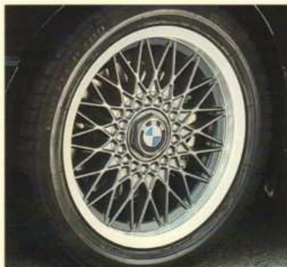
Sichere Basis. Leichtmetallräder 7 1/2 J x 16 im Kreuzspeichen-Styling mit Felgenstern, in Nogarosilber lackiert, und Hochgeschwindigkeitsreifen 225/45 ZR 16.
