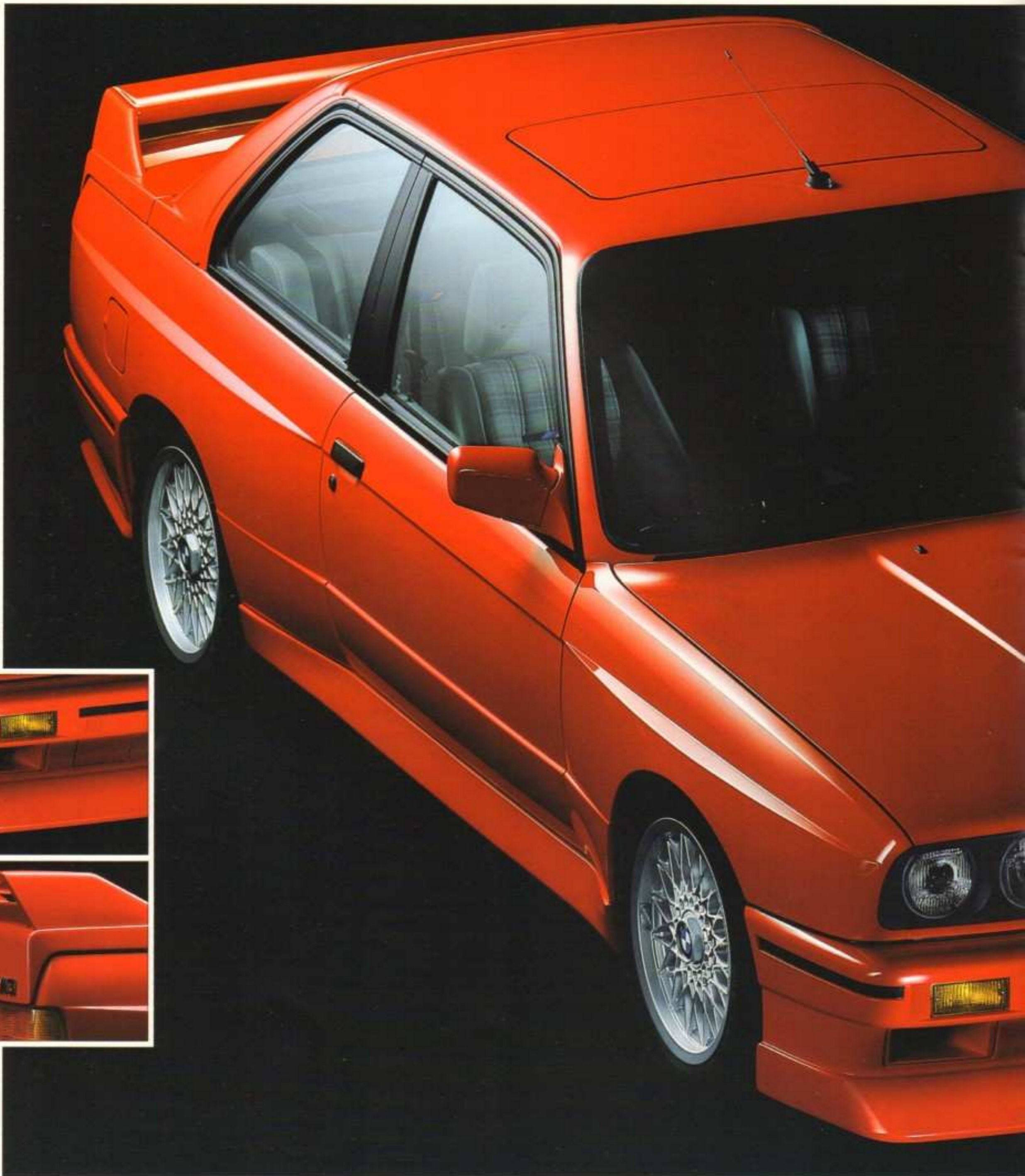
Wind-Stärke als Sicherheitsmerkmal: Neue Front- und Heckspoiler des M3 Evolution reduzieren den Auftrieb durch den Fahrtwind praktisch auf Null.
