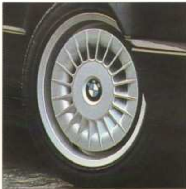
Von der BMW Motorsport GmbH für den M5 entwickelt: die geschmiedeten M Technic Leichtmetallräder mit 17 Zoll Durchmesser. Auf Wunsch mit noch breiteren Super-Niederquerschnitt-Reifen der Größe 255/40 ZR 17 für die Hinterachse.
