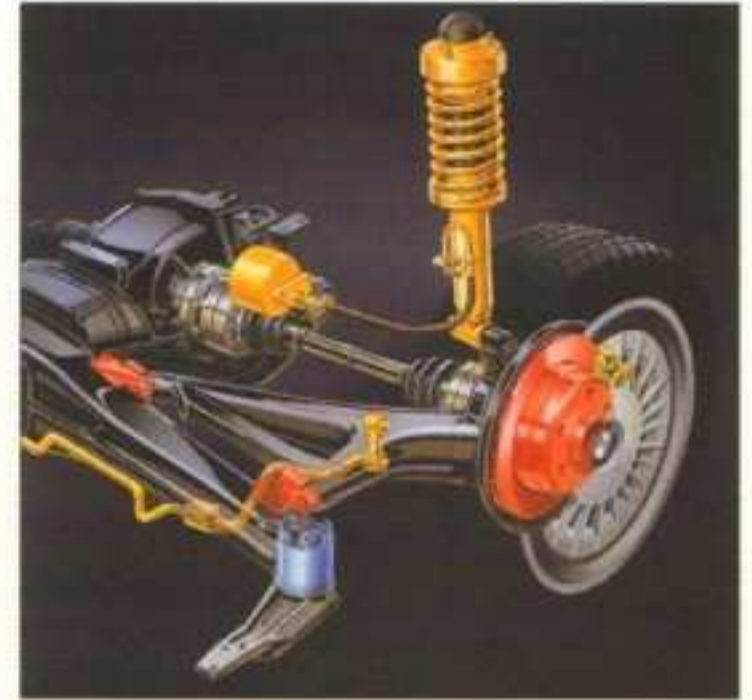
Ein wichtiges Teil des ausgewogenen Fahrwerks ist die Präzisionslenkerhinterachse: Verstärkte Stabilisatoren und die Niveauregulierung verringern die Seitenneigung in Kurven.
