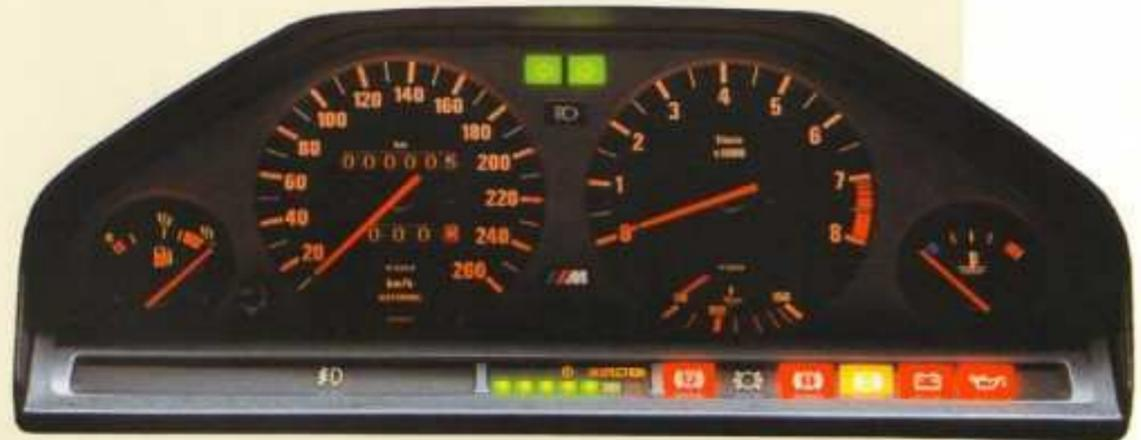
Die Prägnanz des M3-Cockpits: Primäre Funktionsanzeigen, z.B. für Geschwindigkeit und Motordrehzahl, sind optimal im Sichtfeld des Fahrers platziert. Ihre Zeiger informieren im M3 in der Farbe mit der höchsten Signalwirkung: Rot.
