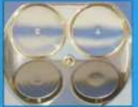
Der M5-Sechszylinder ist weltweit einer der leistungsfähigsten 4-Ventil-Saugmotoren mit Katalysator. Die Überlegenheit hat Ursachen: Extrem kompakte Brennräume des neuen M5-Triebwerks erlauben z. B. eine hohe Verdichtung knapp unter der Klopfgrenze. Resultat: optimale, emissionsarme Verbrennung durch kurze, effektive Flammfronten.
