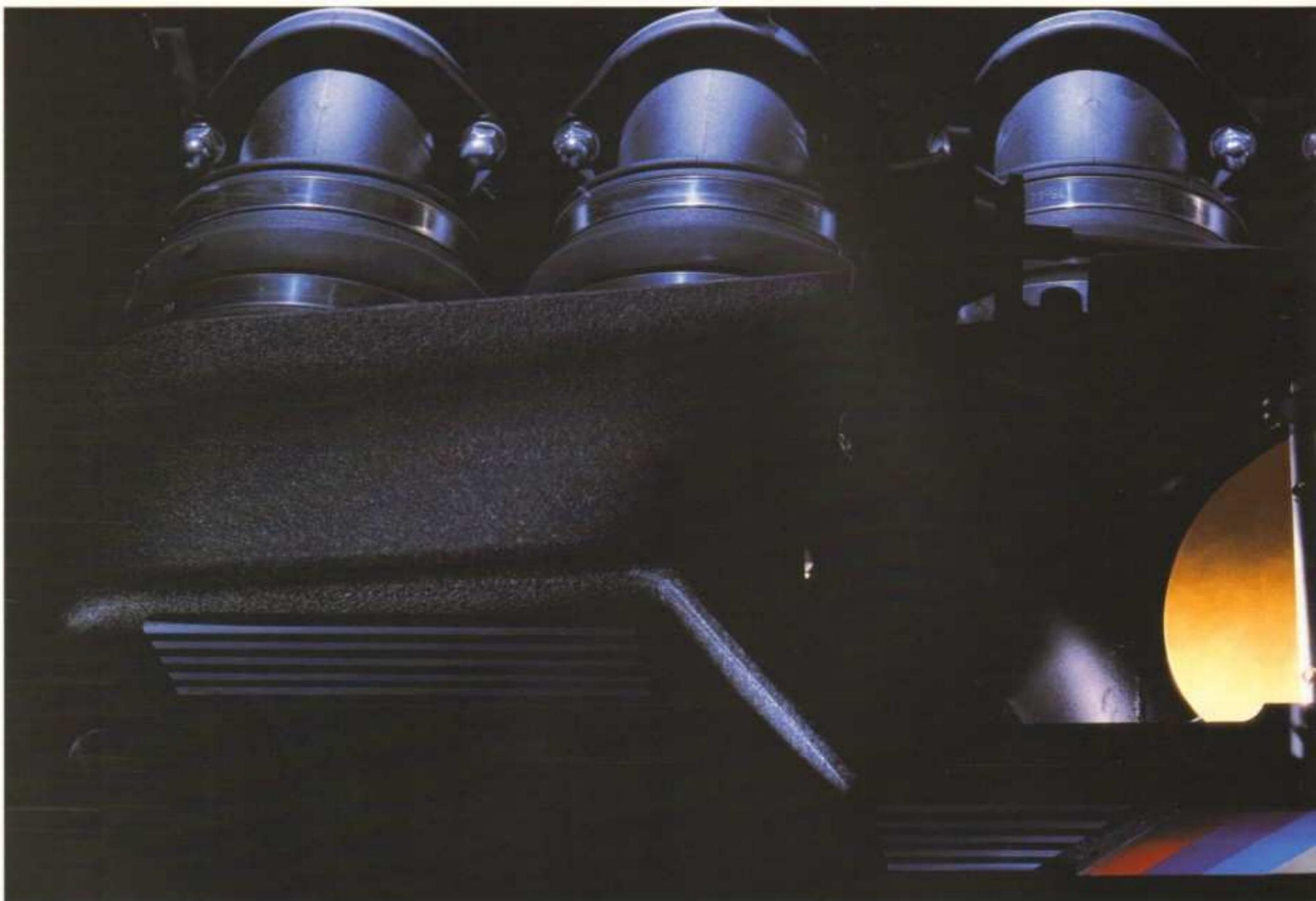
Reihen-6-Zylinder, 4-Ventil-Zylinderkopf mit zwei obenliegenden Nockenwellen, sechs Einzel-Drosselklappen und Fächer-Auspuffkrümmer, 232 kW/315 PS bei 6900/min, Drehzahlbegrenzung bei 7200/min, maximales Drehmoment 360 Nm bei 4750/min — die geballten Merkmale beschreiben die konstruktiven Details eines lupenreinen Hochleistungstriebwerks. Seine über-
