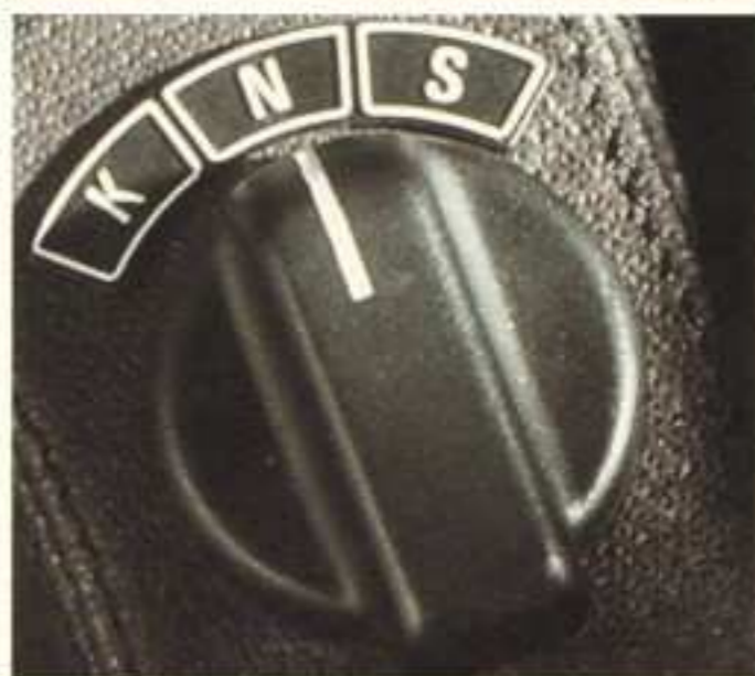
Komfort oder Sportlichkeit auf Knopfdruck. Die neue Elektronische Dämpfer Control (EDC) von BMW. Sie bietet eine Fahrwerkscharakteristik nach Belieben.
