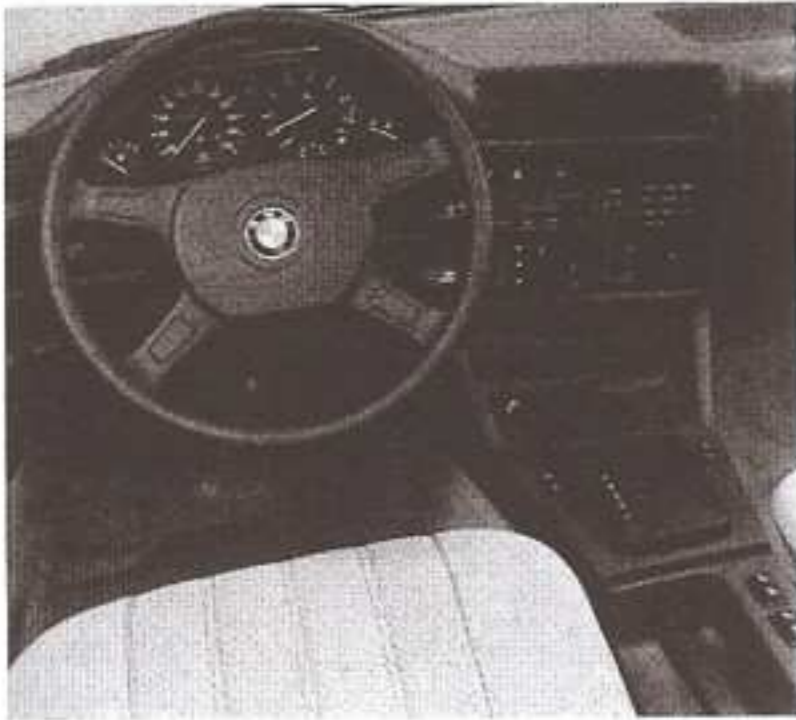
Bild 4: Armaturentafel mit zentraler Instrumenteneinheit in der Primärzone und Sekundärzone für Heizung, Radio und Bordcomputer
