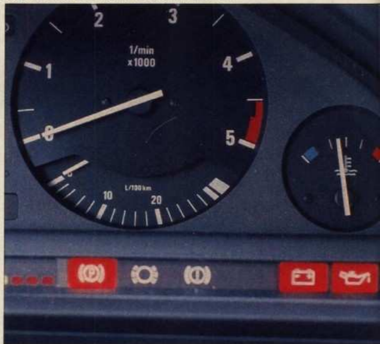
Drehzahl- und Verbrauchsanzeige zusammen in einem Gerät
