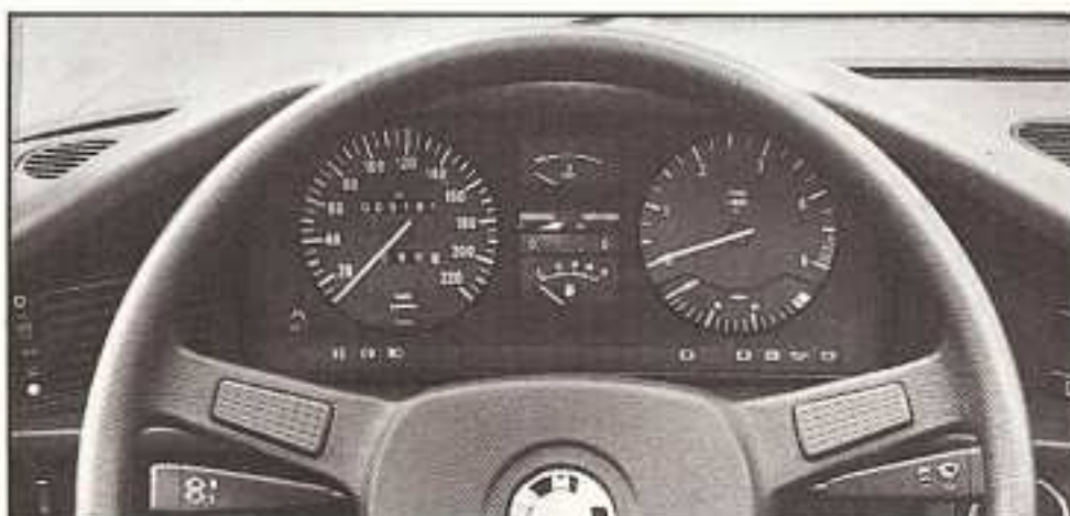
Die Skala des Drehzahlmessers reicht nur bis 5000/min
