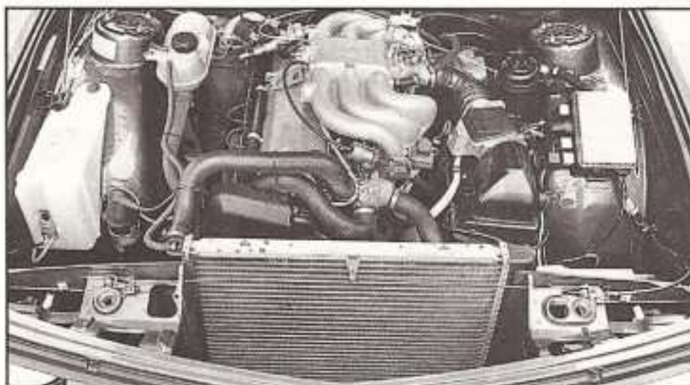
Das eta-Triebwerk verfügt über deutlich längere Ansaugrohre...
