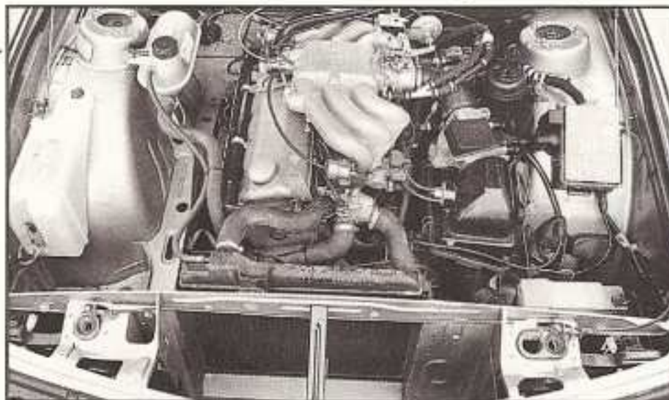
...und einen größeren Kühler als der 520 i-Motor
